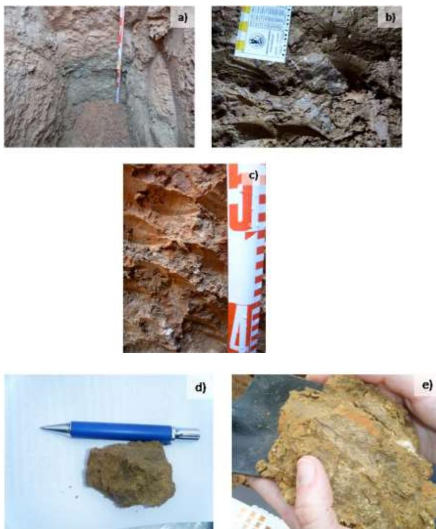
Figura 8. Horizonte 1,50 – 2 m calicata 1ETP. a) Vista general del horizonte; b) detalle de slickenside; c) zona más arcillosa y rojiza; d) slickenside y detalle de agregados de carbono; e) detalle conducto relleno de arcilla y rasgos edáficos de raíces negras.
