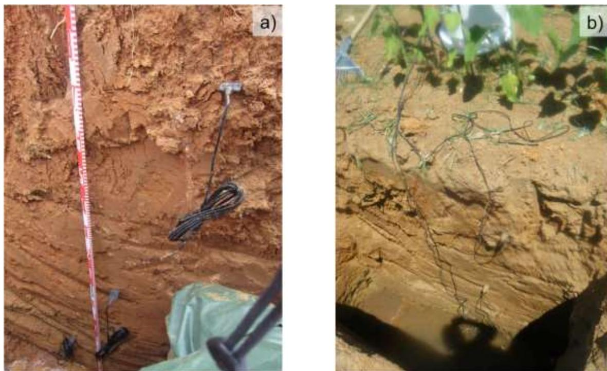
Figura 15. Sondas instaladas en la calicata 1ETP.
