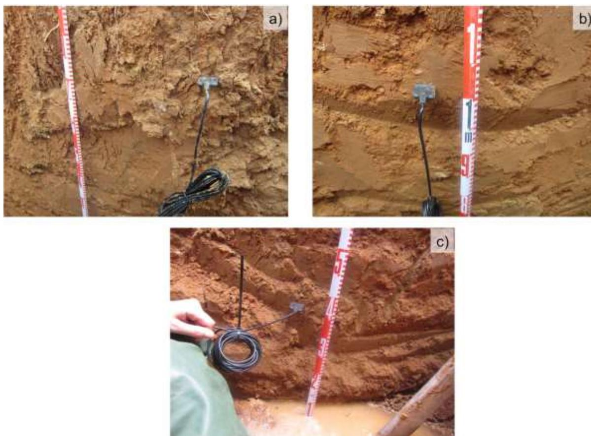
Figura 14. Instalación de sondas de humedad en calicata 1ETP a) Sonda instalada a 0,30 m; b) sonda instalada a 1,05 m; c) sonda instalada a 1,65 m.
