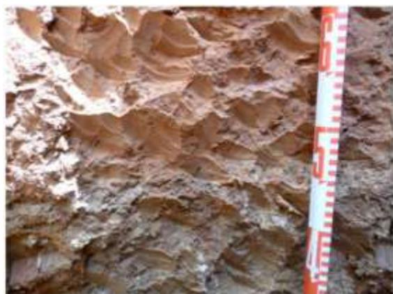
Figura 7. Límite neto entre los horizontes 1,10 – 1,50 m y 1,50 – 2 m de profundidad de la calicata 1ETP.
